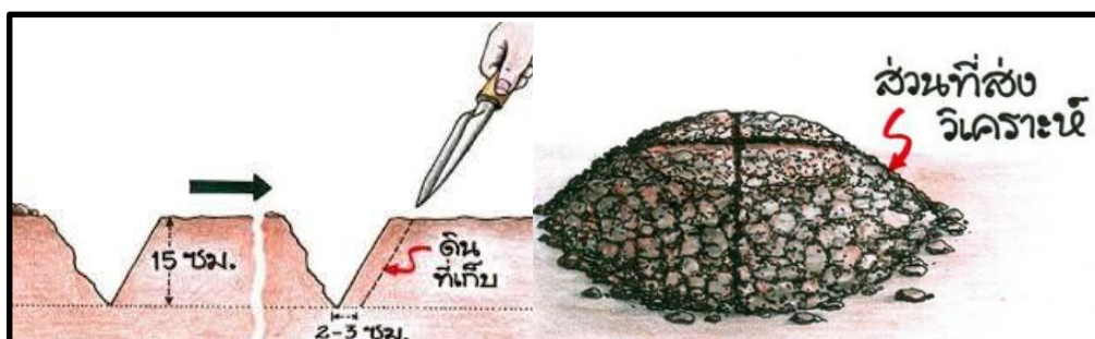
ภาพที่ 38 แสดงเทคนิคในการสุ่มเก็บดินเพื่อนำไปส่งวิเคราะห์ธาตุอาหาร ที่มา : ดัดแปลงจาก สำนักงานเกษตรจังหวัดลำปาง (2563)
