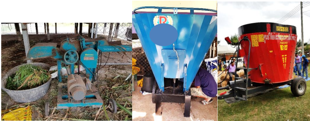
ภาพที่ 36 เครื่องสับหญ้า (ก) เครื่องผสมอาหาร TMR (ข) และเครื่องสับผสมอาหาร TMR (ค) ที่มา : ภาพโดย ไชยวรรณ วัฒนจันทร์
